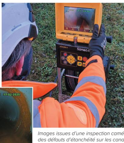
Images issues d'une inspection caméra montrant des défauts d'étanchéité sur les canalisations
